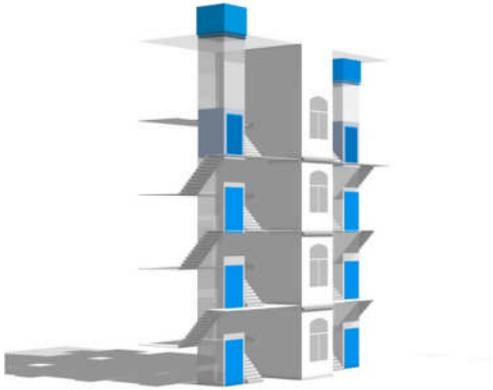
Durch die Schachtkopfhöhe von 2,5 Metern entfällt ein Dachaufbau.
