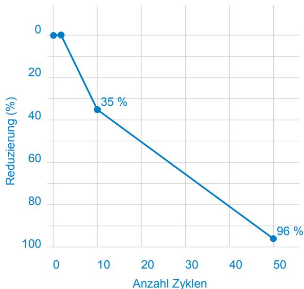
In einer Rolltreppe, die mit dem KONE Handrail-Sanitizer ausgestattet war, wurden 96 % des MS2-Bakteriophagen-Virus in 50 Zyklen (10 Sekunden UV-C-Bestrahlung des Handlaufs) reduziert.
