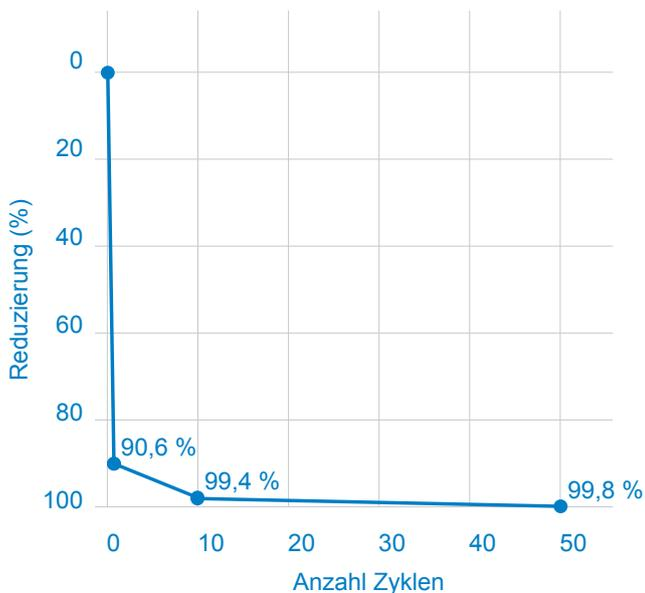
In einer Rolltreppe, die mit dem KONE Handrail-Sanitizer ausgestattet war, wurden 99,8 % der *Escherichia coli*-Bakterien in 50 Zyklen (10 Sekunden UV-C-Bestrahlung des Handlaufs) reduziert.
