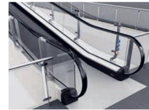
Sturzsicherungsabschrankung für Fahrgäste in einer Höhe bis zu 1'300mm. Empfohlen, wenn ein Sturz von mehr als 6m möglich ist.
