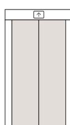
Rahmen: KES 202, 602 und 800 mit seitlich 120 mm und oben 150 mm Rahmenbreite
