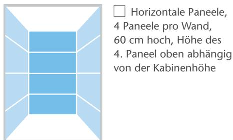
Horizontale Paneele, 4 Paneele pro Wand, 60 cm hoch, Höhe des 4. Paneel oben abhängig von der Kabinenhöhe
