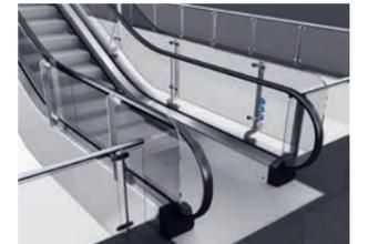
Barrière de protection anti-chute de passagers, jusqu'à une hauteur de 1300 mm. Elle est recommandée si une chute de plus de 6 m est possible
