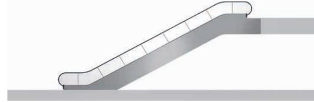
En standard, les joints entre les volumes verriers de la balustrade sont disposés perpendiculairement à la charpente. Les panneaux inclinés ont une largeur de 1200 mm, à l'exception du panneau supérieur dont la largeur est variable afin de compenser l'élévation.
